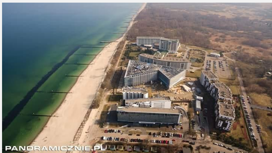
Widok na część nadbrzeżną wschodniej dzielnicy uzdrowskiej w Kołobrzegu. Widoczna jest plaża z rewą oraz ostrogami (po rewitalizacji). W kierunku Wschodnim widoczna jest abrazja brzegu morskiego.
